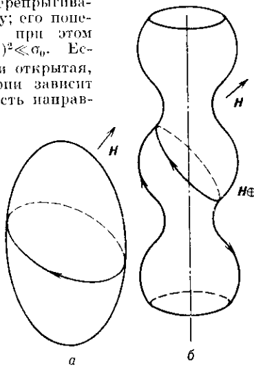
Рис. 3. Примеры траекторий электронов в пространстве квазиимпульсов: а — на замкнутой поверхности Ферми траектории при любом направлении H замкнуты; б — на открытой поверхности Ферми при одних направлениях H они замкнуты, при других — открыты.
