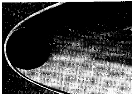
Рис. 4. Фотография сферы, летящей с гиперзвуковой скоростью.
