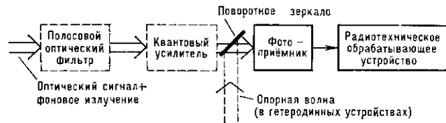
Рис. 1. Схема устройств прямого и гетеродинного детектирования.
