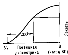
Рис. 2. Зависимость яркости свечения экрана Э от потенциала диэлектрика.
