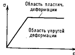
Рис. 6. Зависимость между напряжением \sigma и деформацией \epsilon при упругопластическом изгибе бруса.
