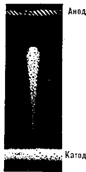
Рис. 2. Фотография электронной лавины, полученная в камере Вильсона.
