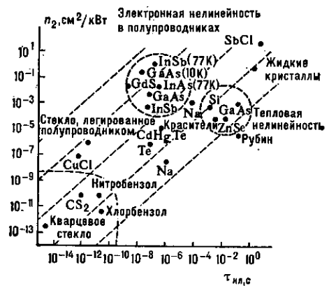
Рис. 3. Значения нелинейного коэффициента n_2 для оптических материалов на плоскости n_2, \tau_{нл} .
