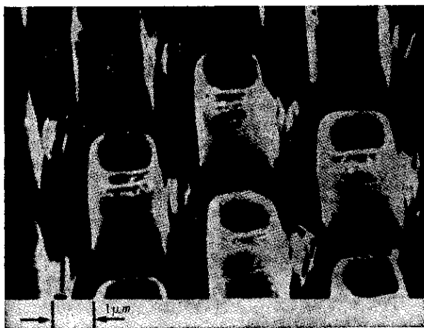
Рис. 16. Ячейка оптических бистабильных микрорезонаторов GaAs — элемент процессора полностью оптического компьютера. Характерный размер \sim 2 мкм.
