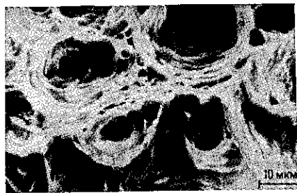
Рис. 3. Микрофотография поверхности излома кристалла молибдена при вязком разрушении.
