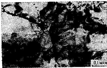
Рис. 7. Зародышевая микротрещина (в кружке) в пластически деформированном кристалле Мо.
