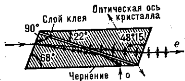
Рис. 1. Призма Николя. Штриховка указывает направление оптических осей кристалла в плоскости чертежа. Направления электрических колебаний световых волн указаны на лучах стрелками (колебания в плоскости рисунка) и точками (колебания перпендикулярны плоскости рисунка), о п е — обыкновенный и необыкновенный лучи. Чернение нижней грани призмы поглощает полностью отражаемый от плоскости склейки обыкновенный луч.
