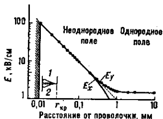
Рис. 2. Зависимость напряжённости электрического поля E от расстояний r частицы до сигнальных проволоочек: 1 — область газового усиления; 2 — область высокой плотности пространственного заряда.
