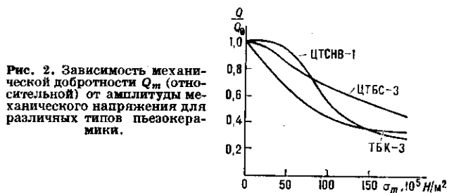
Рис. 2. Зависимость механической добротности Q_m (относительной) от амплитуды механического напряжения для различных типов пьезокерамики.
