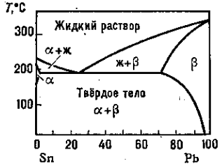
Рис. 6. Фазовая диаграмма системы Sn — Pb эвтектического типа. \alpha , \beta — твёрдые растворы. Точка пересечения трёх линий, в которых сосуществуют жидкая и две твёрдые фазы, — точка эвтектики.
