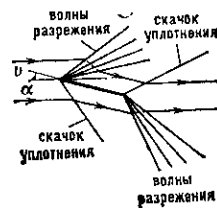
Рис. 4. Схема обтекания пластинки сверхзвуковым потоком.
