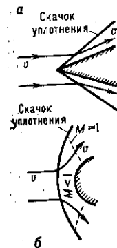
Рис. 3. Обтекание сверхзвуковым потоком: а — клина; б — тупого тела.
