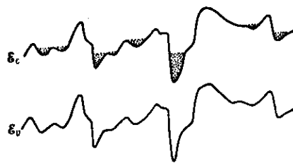
Рис. 2. Энергия носителей заряда в поле примесей при сильном легировании полупроводника.
