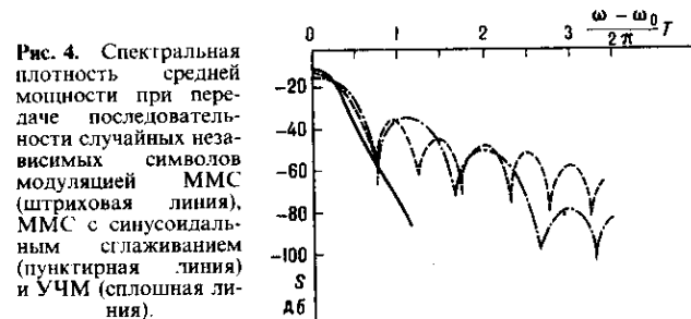
Рис. 4. Спектральная плотность средней мощности при передаче последовательности случайных независимых символов модуляцией ММС (штриховая линия), ММС с синусоидальным сглаживанием (пунктирная линия) и УЧМ (сплошная линия).
