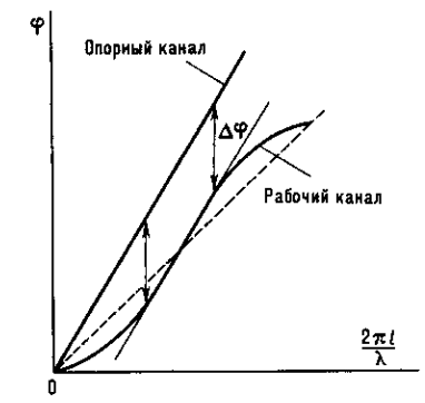
Рис. 2. Фазочастотные характеристики рабочего и опорного каналов фазовращателя на связанных линиях передачи.
