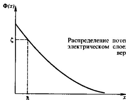
Распределение потенциала  $\Phi(x)$  в двойном электрическом слое;  $x$ —расстояние от поверхности.
