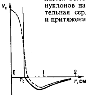
Рис. 2. Схематический вид центрального NN-потенциала с жёстким кором (сплошная линия) и с мягким кором (штриховая линия); r — расстояние между нуклонами, r_c — радиус жёсткого кора.
